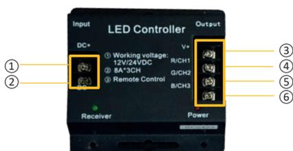
“①” “②”: Morsetti di Input (input Voltage: DC12/24V):
