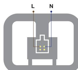
\*Questo LED 2D 4Pin non è adatto per circuiti con ballast/accenditore elettronico (ECG). In circuiti ECG è necessario eliminare il ballast/accenditore e collegare direttamente in AC.
